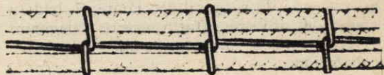
Fig. 5 - I conduttori che collegano la parte di circuito montata sulla tavoletta di base con quella montata sulla parte frontale sono legati con spago secondo il sistema rappresentato in figura.
